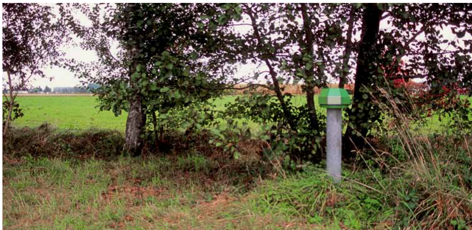
Für die Beobachtung der Wasserflüsse und -mengen stehen im Untersuchungsgebiet 22 Grundwasser-, 6 Oberflächengewässer- und 4 Niederschlagsmessstationen mit kontinuierlicher Datenerfassung zur Verfügung (Bild: Grundwasserpegel in Gerlafingen).
